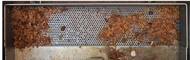
6 Rückstände als dem Krümelblech entfernen. Das Krümelblech muss jeden Tag am Ende des Frittierbetriebs in einen brandsicheren Behälter entleert werden.
