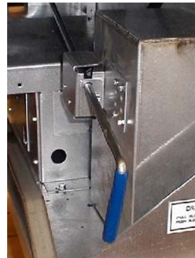
Den Schlauch in die Frittierwanne richten und die Pumpe mit dem vorne montierten Schalter einschalten.
