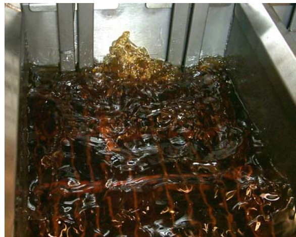
5 Das in die Frittierwanne zurückgeführte Fett 10-15 blubbern lassen; dadurch wird das Fett aus den Rücklaufleitungen gedrückt.
