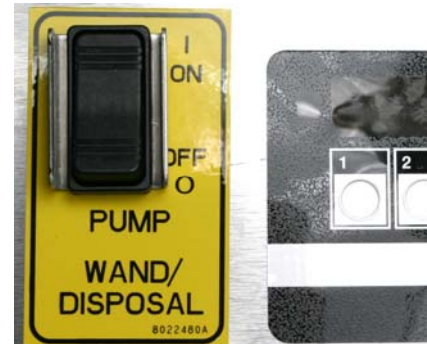
Den Schlauch in die Frittierwanne richten und die Pumpe mit dem vorne montierten Schalter einschalten.
